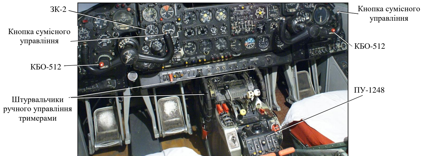
Рис. 4. Розміщення органів управління автопілоту АП-28Л1 і тримерами в кабіні літака АН-24
