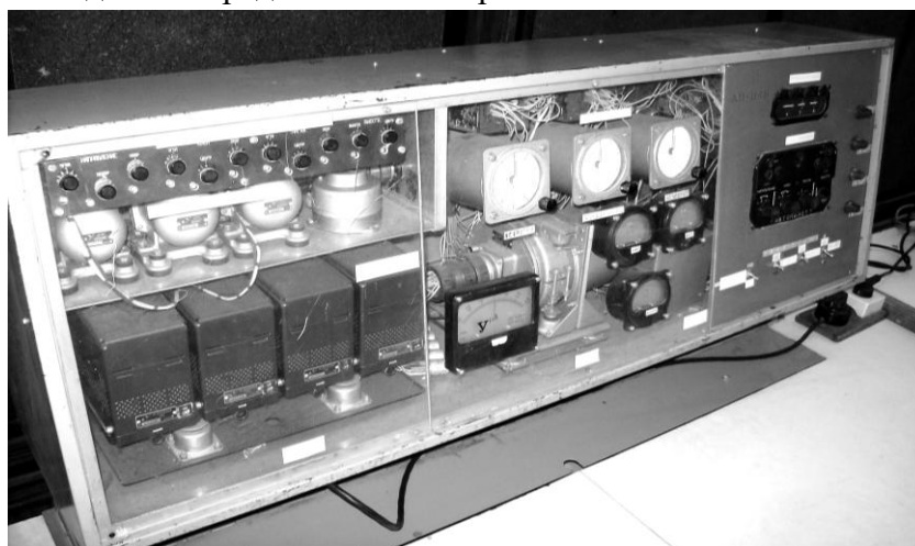
Рис. 10. Лабораторний стенд з проведення досліджень автопілоту АП-34Б
